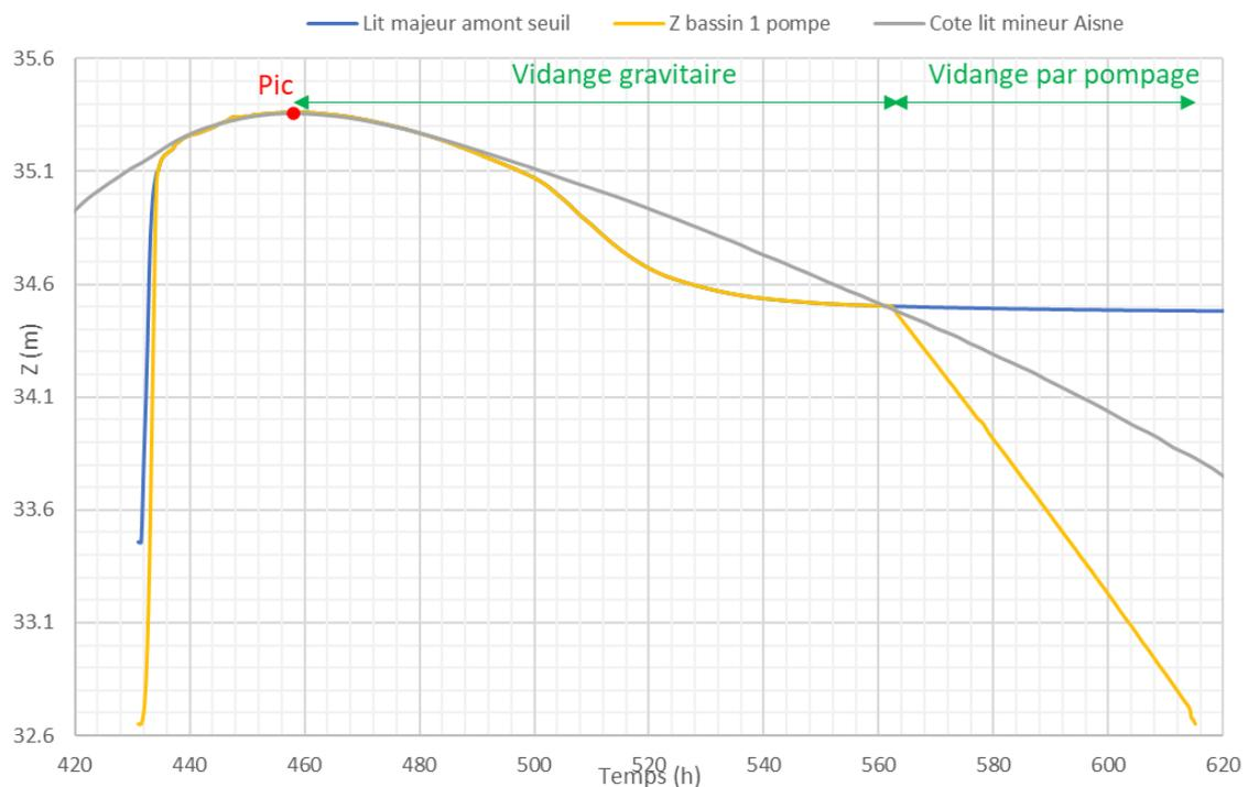
Figure 2-3 : Cote en fonction du temps dans le lit majeur, le bassin de compensation et le lit mineur dans l'Aisne – 1 pompe en fonctionnement
